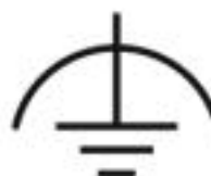
Anschluss des Schutz-Potenzialausgleichleiters
